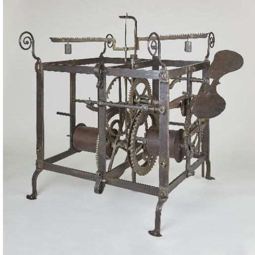
Fig. 1. Meccanismo di orologio da campanile con scappamento a verga e foliot , realizzato in Italia settentrionale alla fine del XIV secolo. Crediti: "Museo Galileo, Firenze. Foto Sabina Bernacchini"
