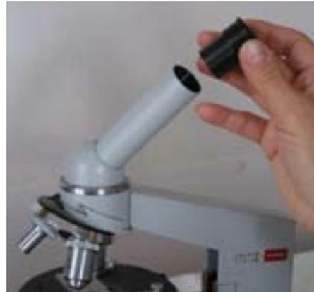
3. fissare con un supporto realizzato ad hoc (spesso basta del nastro adesivo di carta) la telecamera al microscopio. Più esattamente si deve posizionare il foro della telecamera, quello dove normalmente si trova l'obiettivo, nell'alloggiamento del microscopio da dove abbiamo tolto l'oculare. La distanza non è critica, perchè si potrà sempre mettere a fuoco l'immagine con l'apposita manopola del il microscopio stesso
