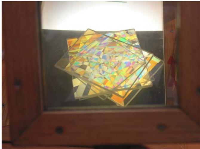
Osserva ora la lastra di vetro con le strisce di nastro adesivo: girando lentamente il filtro noterai che cambiano i colori. Infine prova a ripetere l'esperienza osservando un tubicino di plastica e deformandolo. All'aumentare della deformazione del tubo il filtro ti farà vedere colori diversi.
